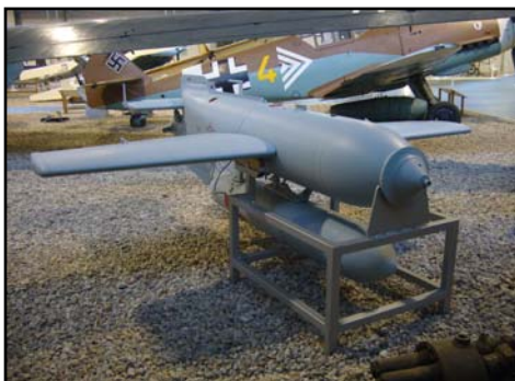
HS 293 som eksponat i Luftwaffenmuseum. Raketmotoren er ophængt under spræghovedet på 500 kg. Missilet var radiostyret og en forløber for de moderne krydsermissiler.
