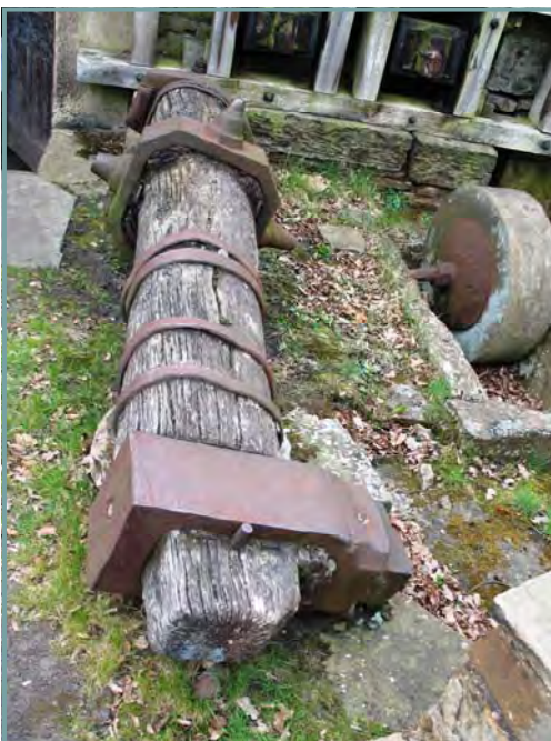
Vandhjulsdrevet smedehammer af typen, som blev brugt på Peyremberts tid
