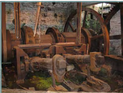
Smedehammerværk af samme type, som Peyrembert formentlig har brugt i Frederiksværk.
